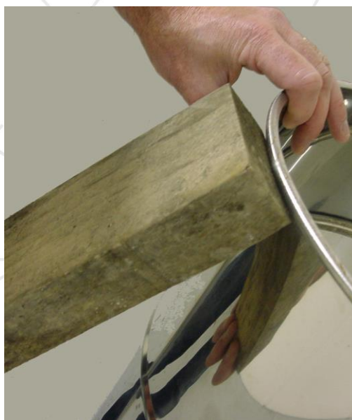
Placer une cale en bois sous le bord roulé de la jupe.
