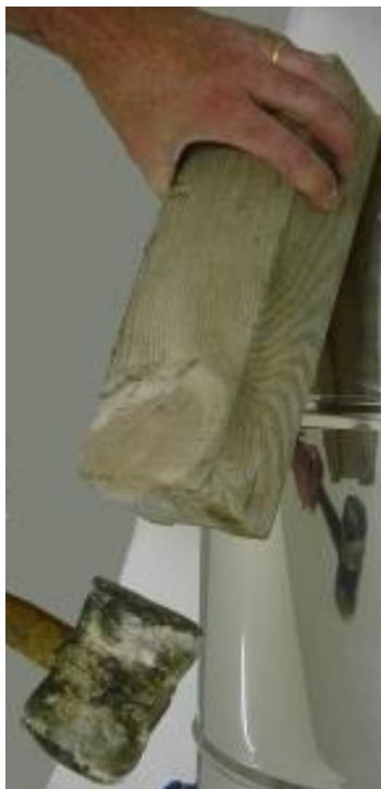
Frapper fermement à l'aide d'un maillet et de la cale pour retirer la jupe.
